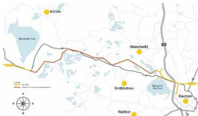
Verlauf der FGL 008 im zu sanierenden Bereich (orange), Norden ist links.
